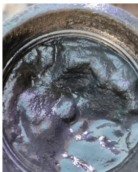
图5 油管被沉降的煤粉堵塞
